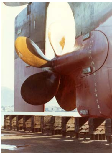
( De sloopsschroef nadat ze gepolijst is en een gedeelte van de sloopshuid en het vlak in de anti aangroeiervf.)
